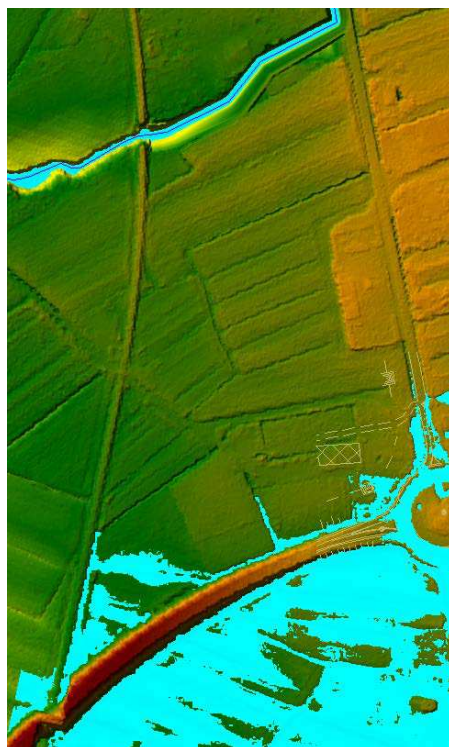
Fig. 6.7 - Modello "Frassine Gavardello", area compresa tra la SR71, la ferrovia Arezzo-Stia, il rilevato di via Turati e il Frassine, allagamento massimo per evento di piena Tr 200 anni
